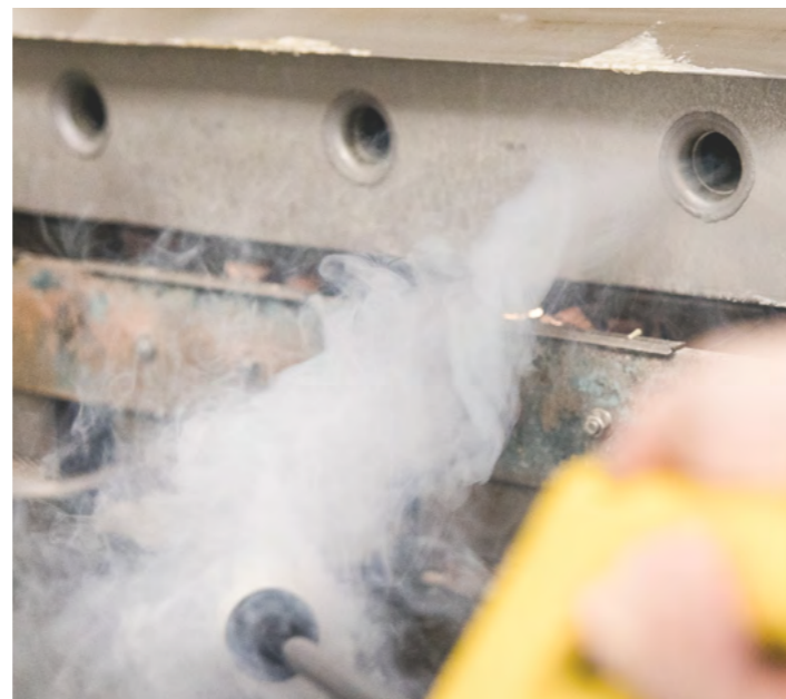
Strömungsoptimierte Absaugbalken für minimale Abluftmengen.
