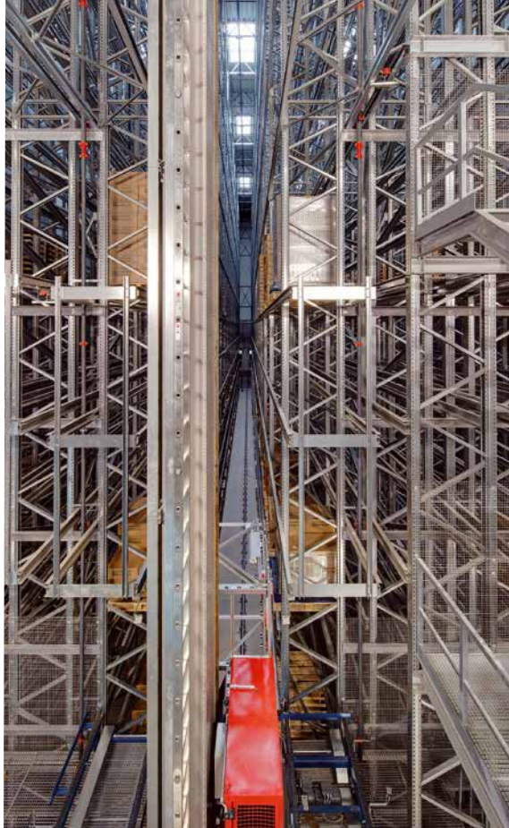
Das neue Lager besteht mit einer Höhe von 27 Metern und 6.500 Paletten-Stellplätzen. Hörburger entwickelte ein spezielles Lüftungssystem zur Beheizung und Konditionierung.
